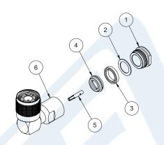
1. SLIDE CLAMP NUT (1), THIN-WASHER (2) & GASKET (3) OVER CABLE. STRIP CABLE AS SHOWN. DO NOT NICK BRAID WHILE CUTTING JACKET. TAPER END OF BRAID TO PERMIT ASSEMBLY OF CLAMP.
