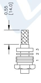
2. FORM BRAID OVER CLAMP NUT (4). TRIM BRAID CENTER CONDUCTOR TO DIMENSION SHOWN. CONTACT TO CENTER CONDUCTOR. REMOVE DO NOT NICK CENTER CONDUCTOR. SOLDER DIELECTRIC. INSERT CABLE ASSEMBLY INTO BACK TO SHOULDER. CUT DIELECTRIC & **EXCESS SOLDER. DO NOT OVER HEAT** BODY & TIGHTEN.
