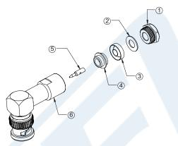
1. SLIDE CLAMP NUT (1), WASHER (2) & GASKET (3) OVER CABLE. STRIP CABLE AS SHOWN. DO NOT NICK BRAID WHILE CUTTING JACKET. TAPER END OF BRAID TO PERMIT ASSEMBLY OF CLAMP.
